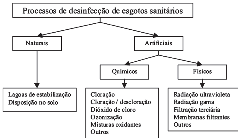
Figura 2.11: Processos de desinfecção de esgoto sanitário (Fonte: GONÇALVES, 2003)
