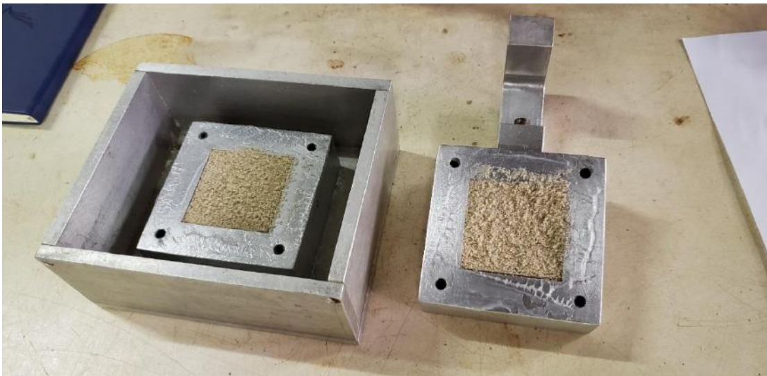
Figura 14. Peró 2 C.P.2 logo após o ensaio. Podemos ver claramente a rugosidade da superfície de ruptura, de onde foi retirada amostra para obtenção do teor de umidade (foto do autor).
