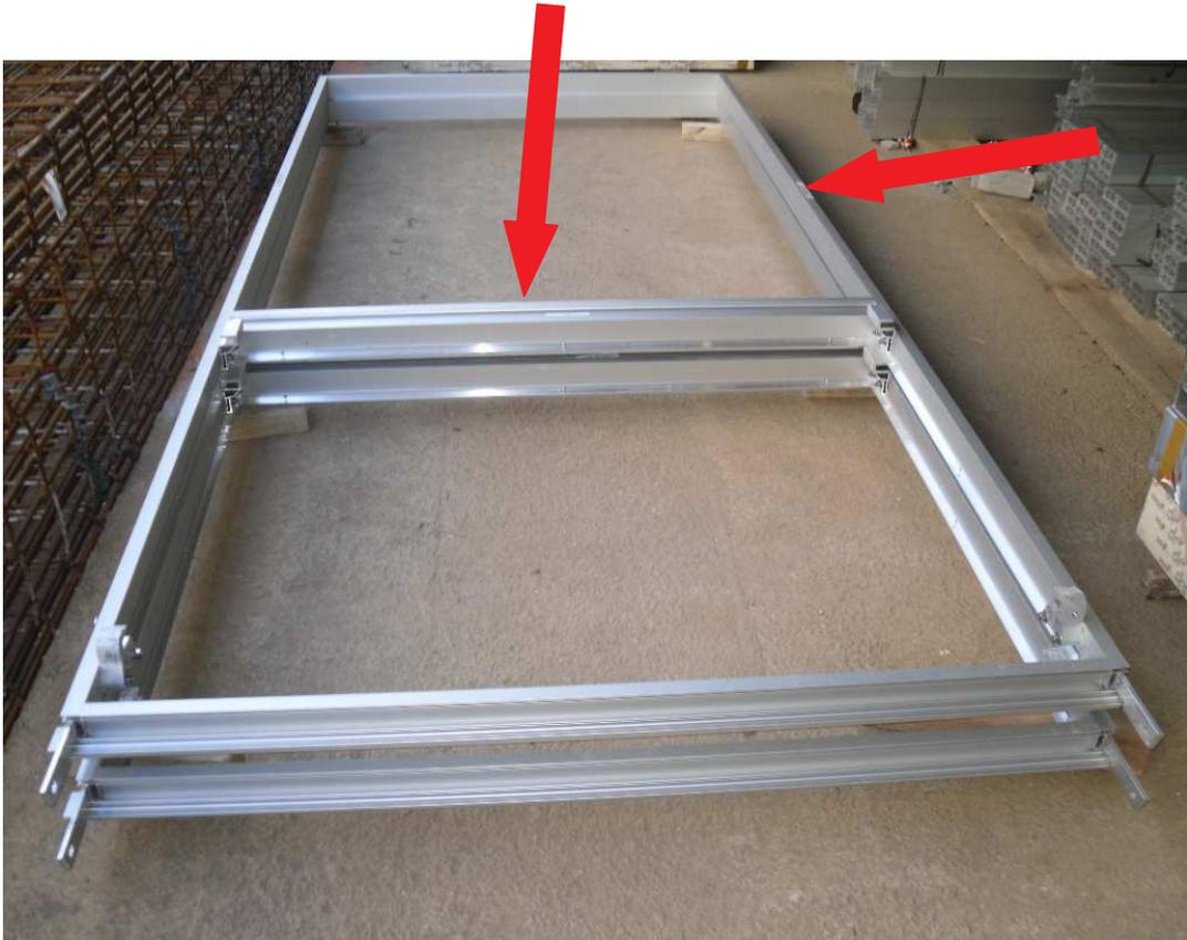
Figura 29 – Quadros prontos para colagem dos vidros
