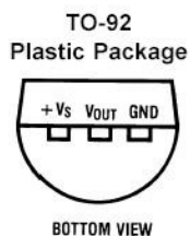
Figura 3.2.1.4 – Encapsulamento do sensor (retirada do datasheet [6])
