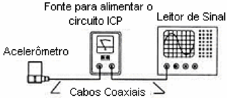
Figura 3.7: Esquema de montagem do sistema de medição[9]
