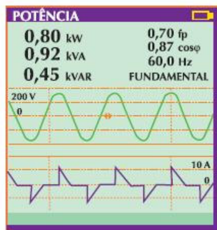
Figura 8 – Forma de onda com diferença entre fator de potência e \cos\phi
