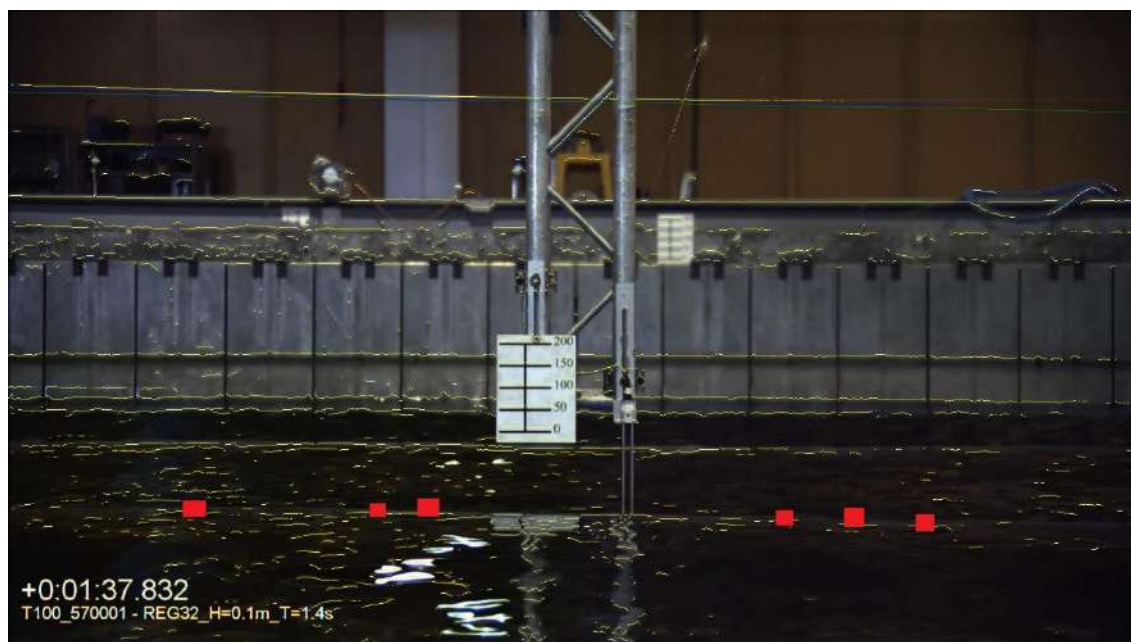
Figura 29: São seis pontos fixos no tanque oceânico a fim de extrair os dados de períodos.
