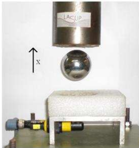
Figura 2.5 - Experiência de levitação eletromagnética.
