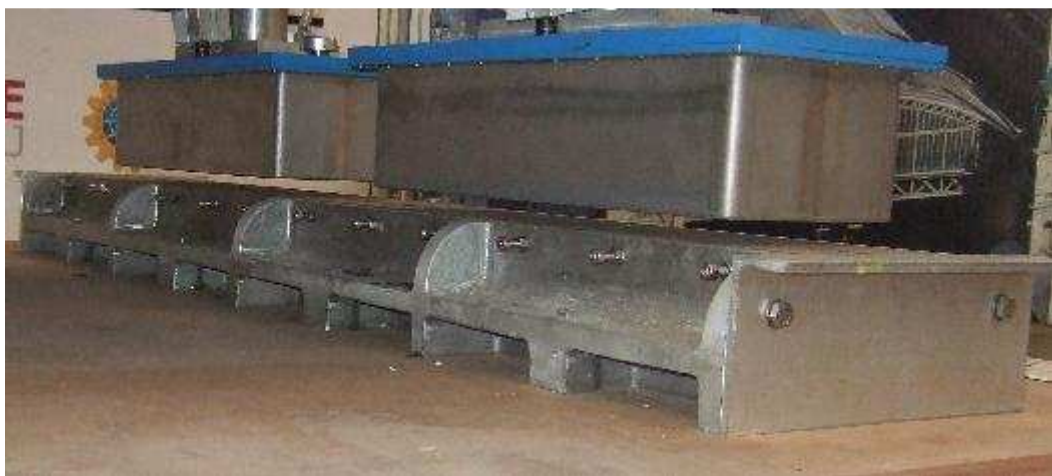
Figura 2.3 - Levitação supercondutora (figura cedida pelo LASUP).
