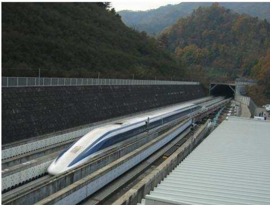
Figura 2.4 - Trem de levitação eletrodinâmica japonês na linha de testes de Yamanashi.
