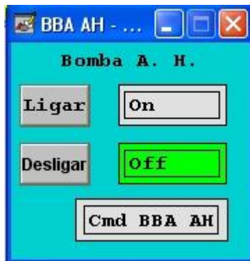
Figura 79: Tela de operação da Bomba AH, com a Bomba AH desligada
