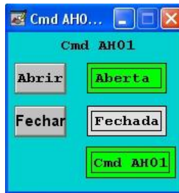
Figura 78: Tela de operação da válvula AH01, com a válvula aberta
