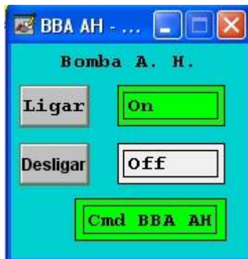
Figura 80: Tela de operação da Bomba AH, com a Bomba AH ligada
