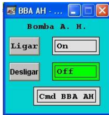
Figura 44: Tela para operação manual da bomba Anti-Heeling
