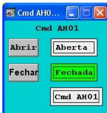
Figura 43: Tela para operação manual das válvulas
