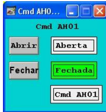
Figura 77: Tela de operação da válvula AH01, com a válvula fechada
