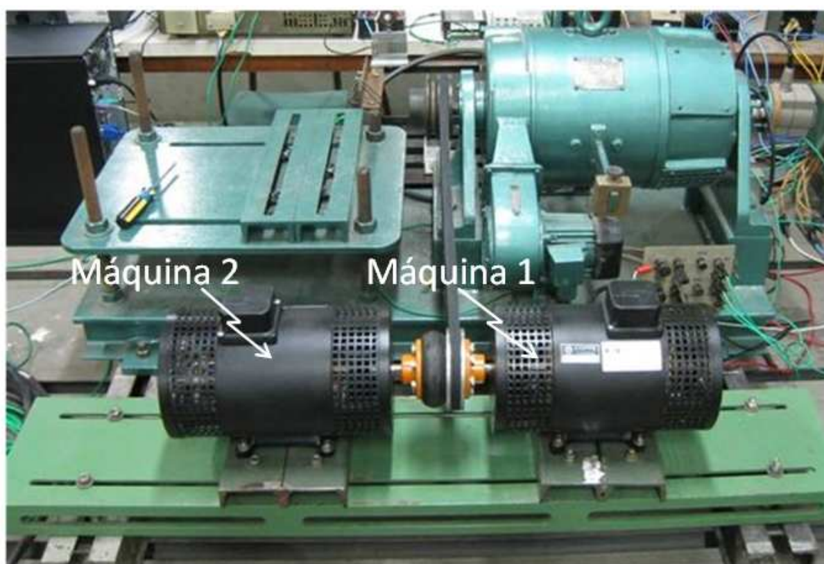
Figura 26 – Máquina de indução de rotor bobinado formando a MICDA
