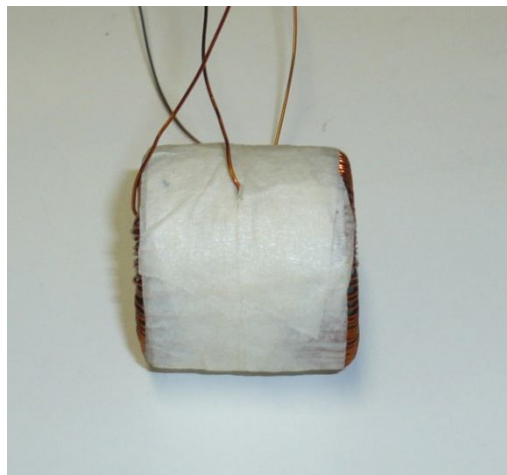
Figura 3.2 – Sensor indutivo fixado com fita adesiva.
