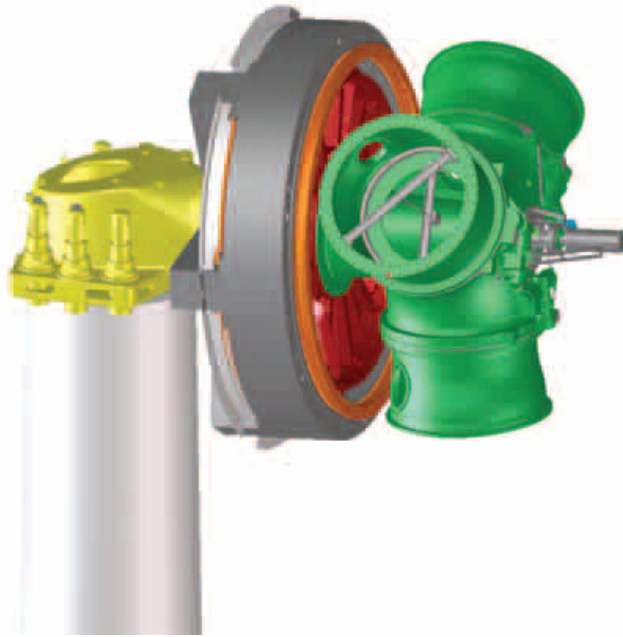
Figura 3.22 – Acoplamento direto do Cubo (verde) ao rotor do gerador (vermelho) [16].
