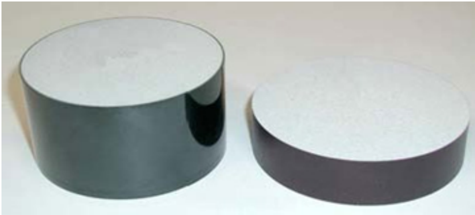
Figura 2.4: Blocos de ZnO usados nos pára-raios
