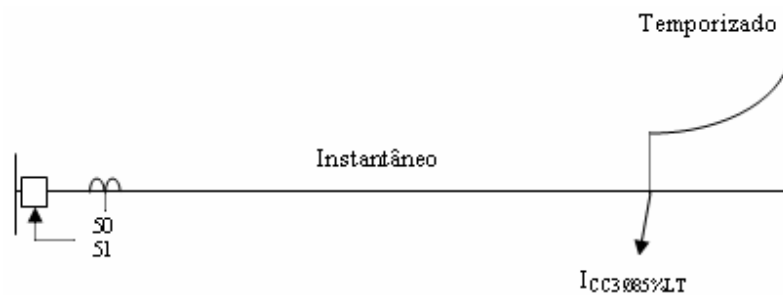
Figura 26 - Exemplo de atuação do relé de sobrecorrente 50/51
