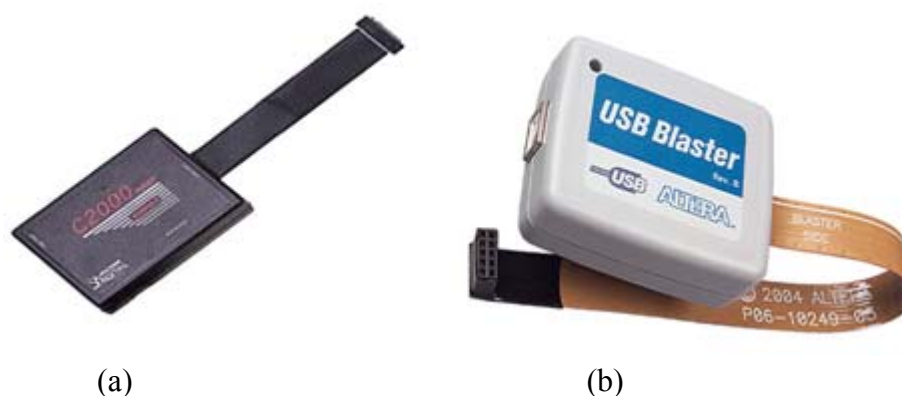
Figura C.7 – (a) JTAG da Texas Instruments C2000™ Series XDS510LC. (b) JTAG da Analog Devices USB-Blaster™, compatível com as famílias de FPGA Stratix, Cyclone, MAX e FLEX 10K. Este modelo de JTAG foi utilizado no kit EP2S60 durante o projeto de construção do protótipo do Amplificador Lock-In .
