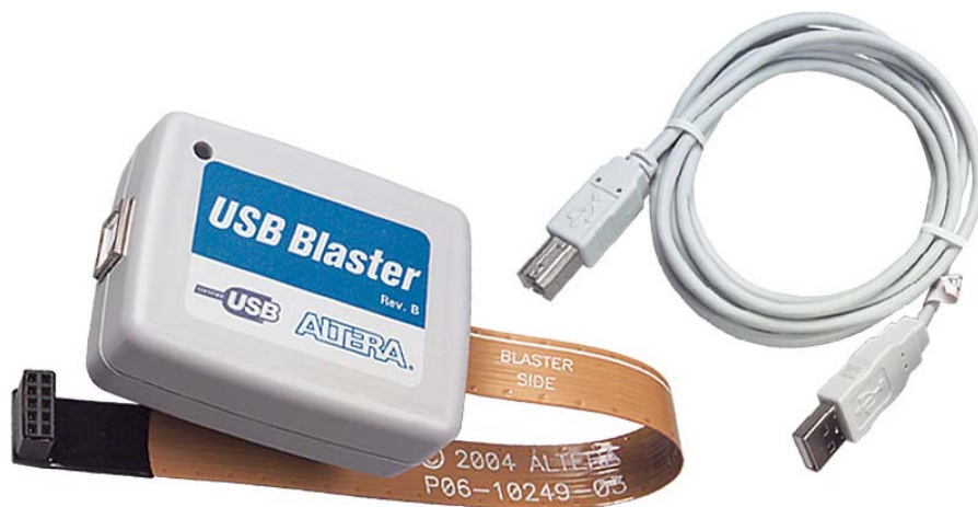
Figura 3.2 – Foto do cabo de dados JTAG USB Blaster, utilizado para comunicação entre o computador e o DSP EP2S60. Este cabo ainda pode ser utilizado para outras famílias de DSP da Altera.
