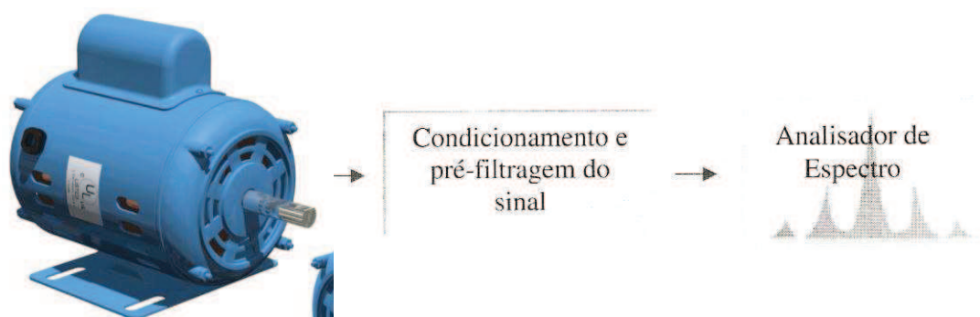
Figura 81 - Sistema Básico para Análise Espectral da Corrente [7]
