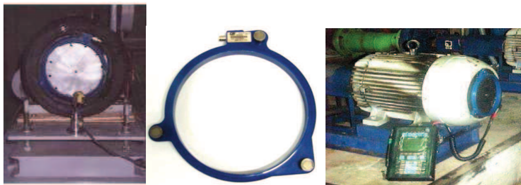
Figura 89 - Bobina de Fluxo Fixada Axialmente e Medição em Campo com a Bobina CSI [9]
