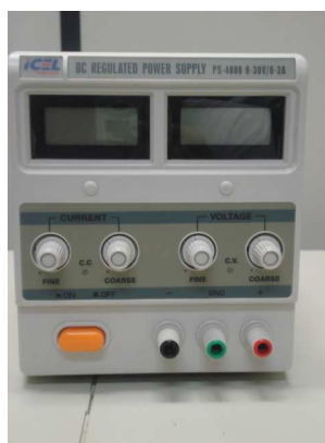
Figura 13 - Foto da fonte regulada simples ICEL, modelo PS-4000
