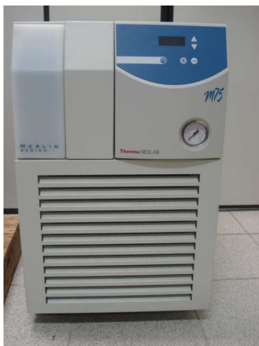
Figura 11 - Foto do sistema de arrefecimento, Thermo Neslab, série Merlin M-75
