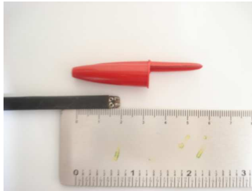
Figura 15 - Foto do sensor Hall ampliada.
