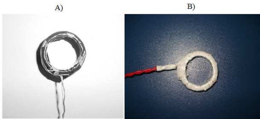
Figura 16 - A) Foto da Bobina 1, utilizada sem material magnético em seu interior. B) Foto da Bobina 2, utilizada com materiais supercondutores.
