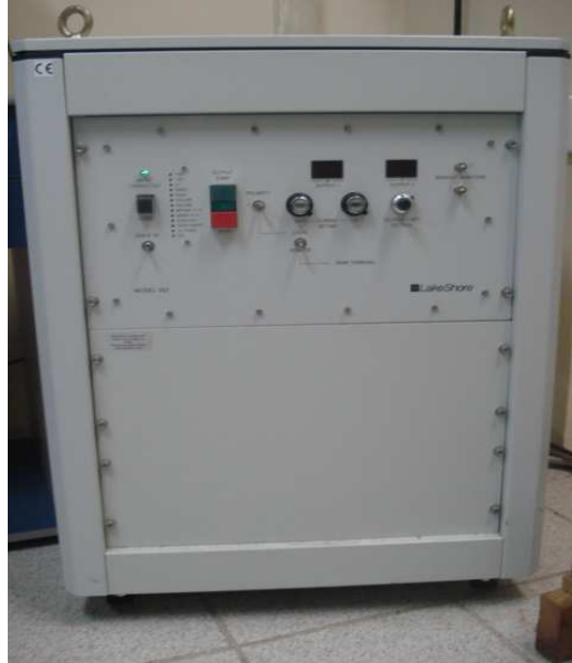
Figura 9 - Foto da fonte de corrente LakeShore, modelo 662.
