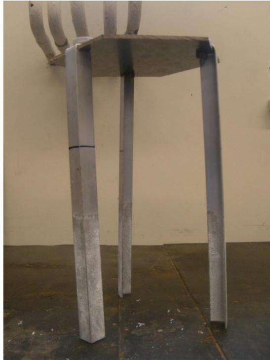
Figura 1.3 – Estrutura de madeira e eletrodos construídos para os ensaios experimentais de eletrólise.
