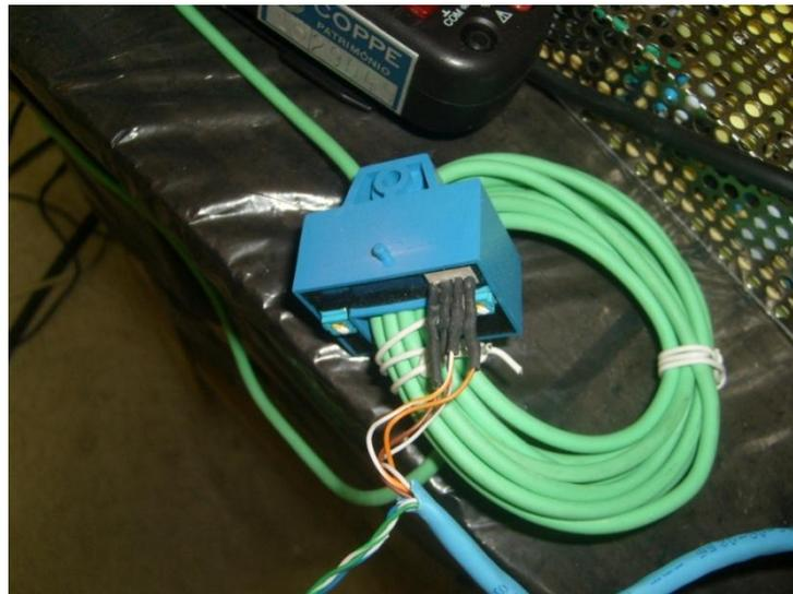
Figura 5.2 – Foto do HAS 100-S utilizado em bancada.
