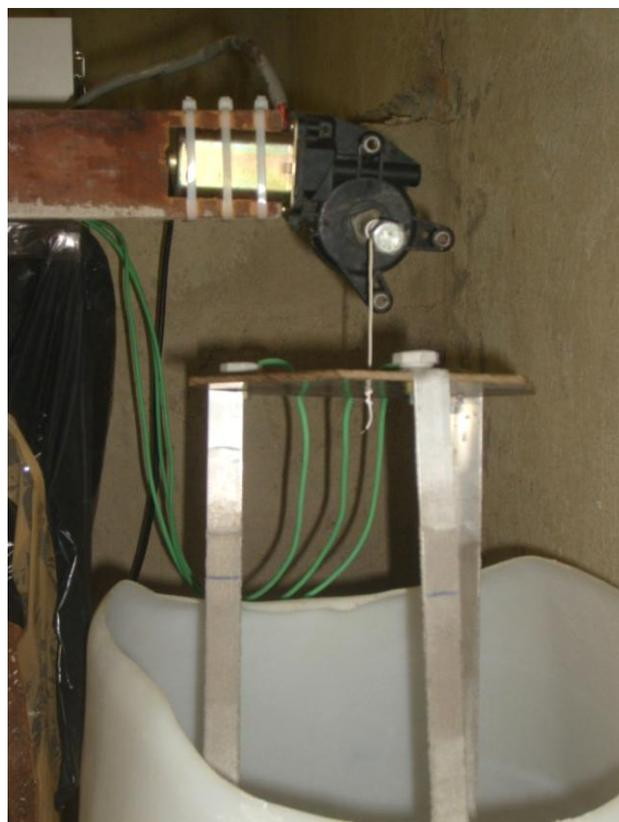
Figura 1.4 – Eletrodos acoplados ao eixo do motor para ensaio experimental de validação do sistema de controle.
