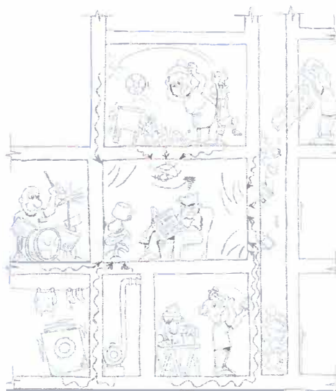
Figura 14 - Transmissão de ruídos de impacto e vibração. Fonte: Souza, 2003: 97.
