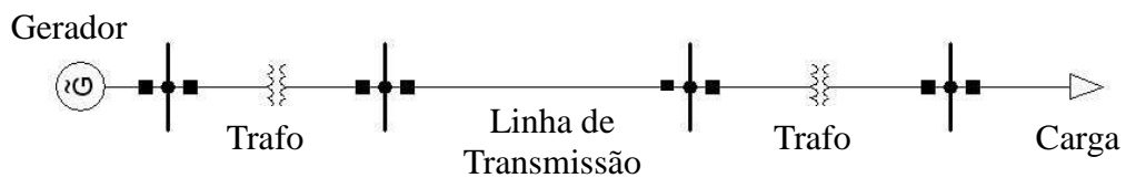
Figura 1 – Sistema elétrico de potência
