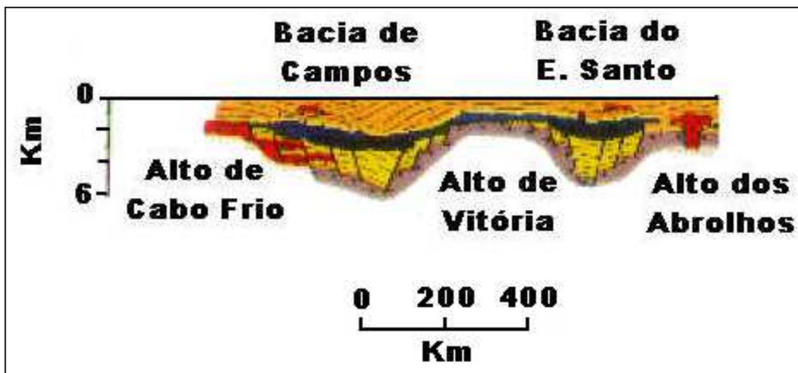
Figura 10: Seção estrutural simplificada demonstrando os limites estruturais da Bacia de Campos. (Fonte: Alterado de Asmus e Guazelli, 1981).
