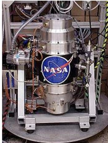
Figura 7 – Foto de um *flywheel* desenvolvido pela NASA, retirada de [21]
