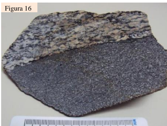
Figura 16 - Amostra com contato retilíneo da fácies diabásio com a fácies gabro médio leucocrático. Ponto JU-227A.
