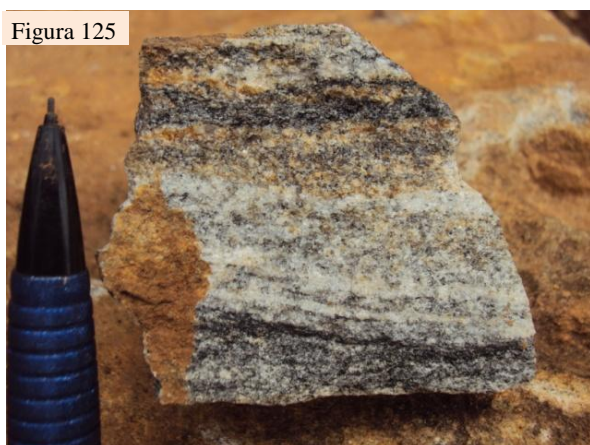
Figura 125 - Gnaisse bandado contendo foliação anastomosada e lentes máficas ricas em biotita boudinadas . Ponto JU-158.
