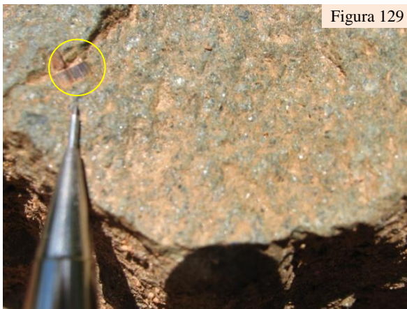
Figura 129 - Rocha ultramáfica rica em anfibólio e clorita, contendo cristal de pirita limonitizada (no círculo amarelo). Ponto JU-10.
