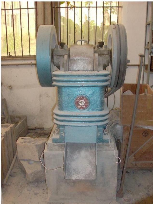
**Figura 3:** Britador de mandíbulas
