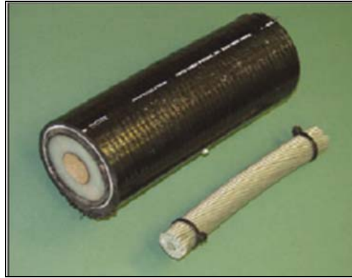
FIGURA 6.2: Comparação entre as seções de um cabo e um condutor nu.
