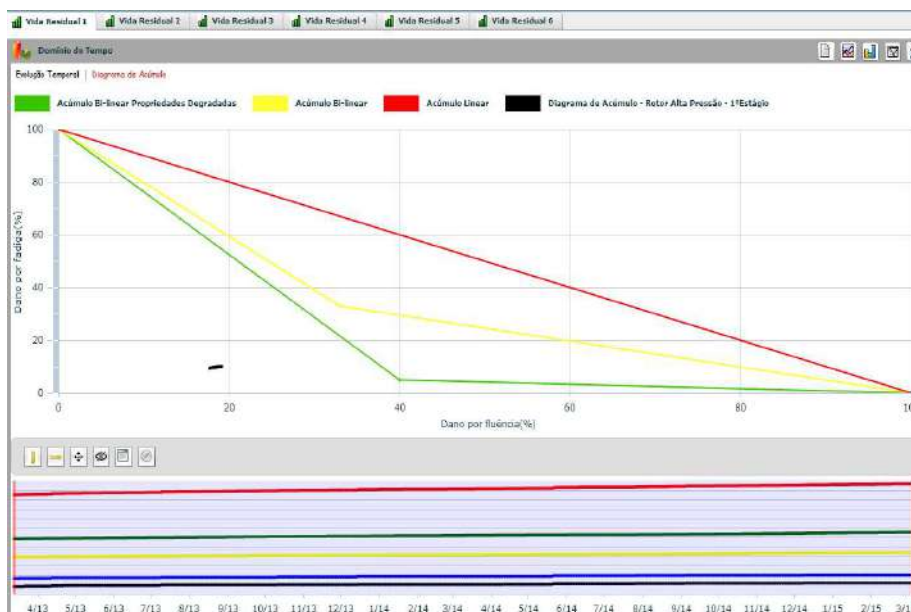
Figura 4.8. Evolução do dano total acumulado por fluência e fadiga termomecânica para o rotor de alta pressão representada no diagrama de acúmulo de dano na interface gráfica do sistema TURBODIAG-SOMA.
