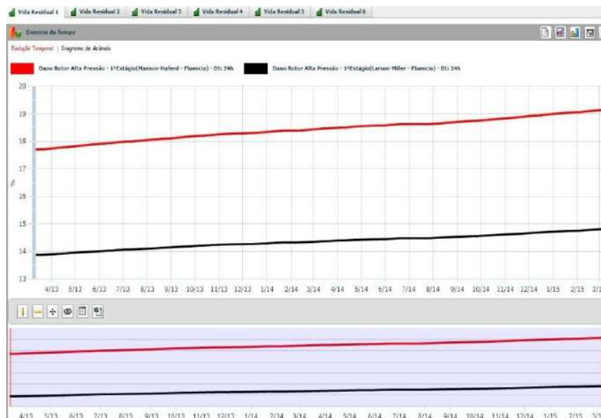
Figura 4.4. Evolução temporal do dano por fluência, calculado pelos métodos de Larson-Miller e Manson-Haferd na interface gráfica do sistema TURBODIAG-SOMA.
