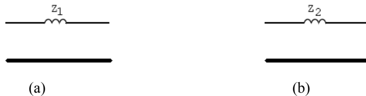
Figura 3.5 - Diagramas de seqüências positiva e negativa de um transformador, (a)Diagrama de seq. positiva, (b)Diagrama de seq. negativa.
