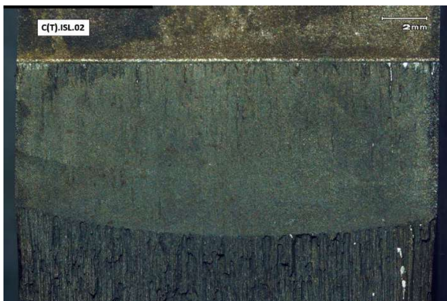
Figura 121 – Imagem em lupa estereoscópica da região da pré-trinca, entalhe e propagação no corpo de prova C(T).ISL.02 ensaiado em meio
