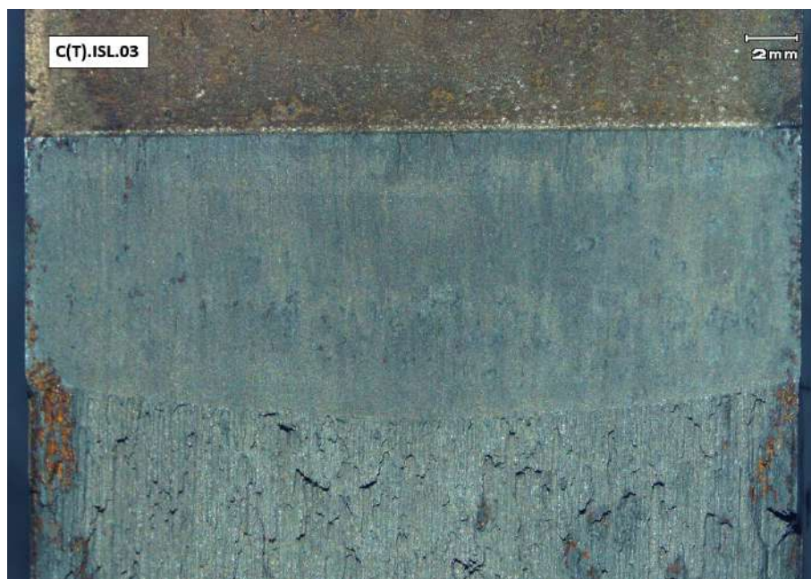
Figura 122 – Imagem em lupa estereoscópica da região da pré-trinca, entalhe e propagação no corpo de prova C(T).ISL.03 ensaiado em meio
