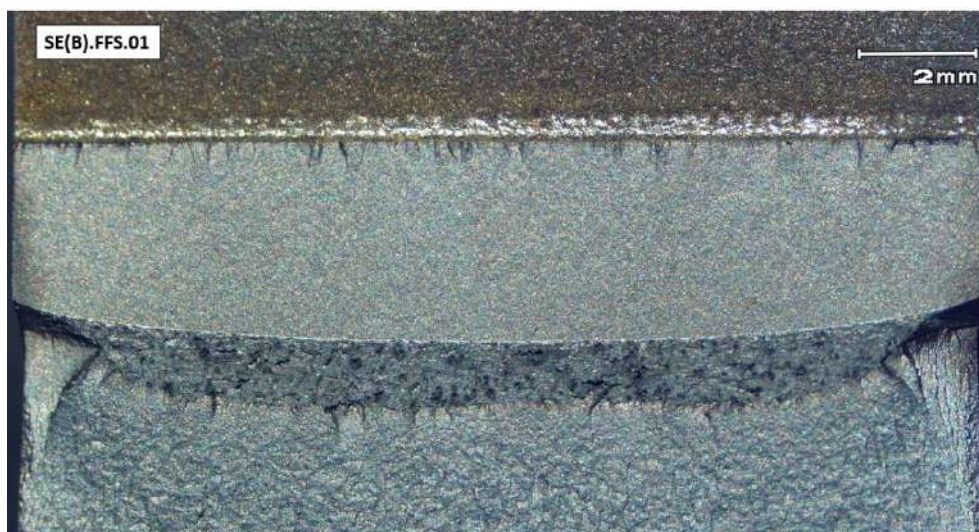
Figura 153 – Imagem em lupa estereoscópica da região da pré-trinca, entalhe e propagação no corpo de prova SE(B).FFS.01 ensaiado ao ar
