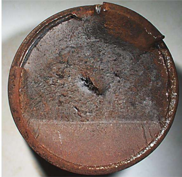
Figura 212 – Foto em lupa estereoscópica da superfície de fratura de um fixador ilustrando a região de propagação subcrítica em fadiga (parte reta inferior) e a região de propagação abrupta
