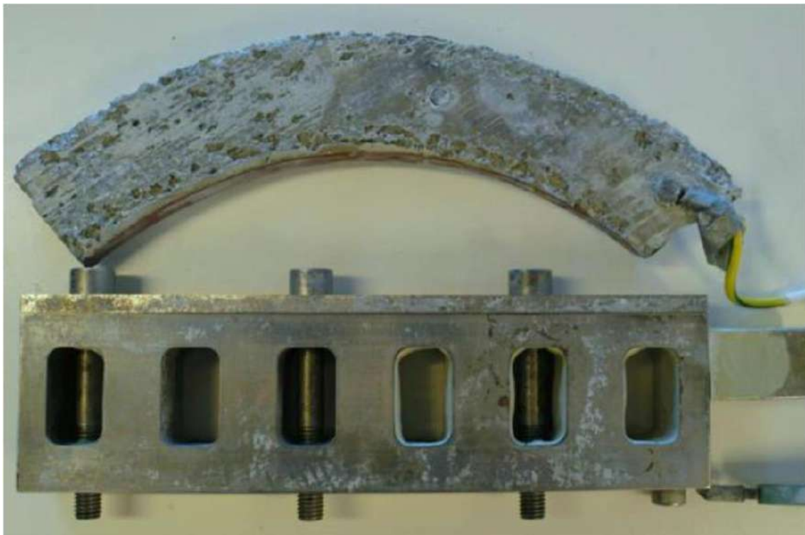
Figura 193 – Foto do dispositivo de teste de fixadores com anodo de alumínio conectado. O dispositivo e o anodo são imersos em cubas de vidro com água do mar sintética (Rorvik et al. , 2014)
