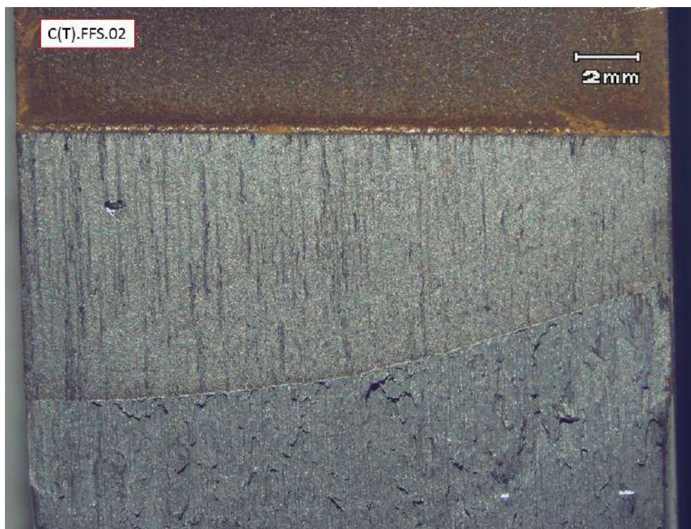
Figura 98 – Imagem em lupa estereoscópica da região da pré-trinca, entalhe e propagação no corpo de prova C(T).FFS.02 ensaiado ao ar
