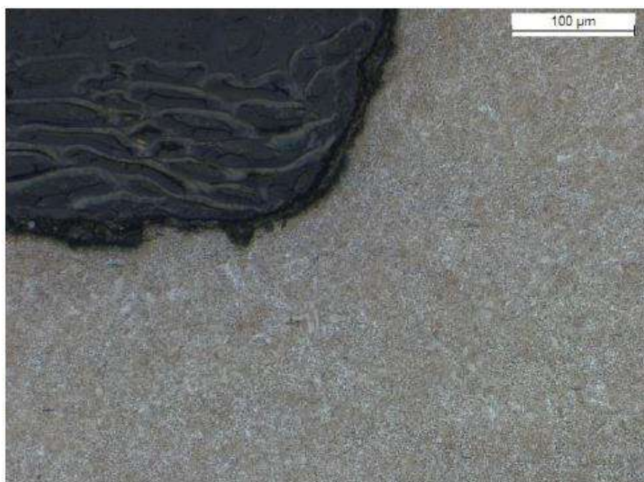
Figura 77 – Metalografia da região superficial em corte longitudinal.
