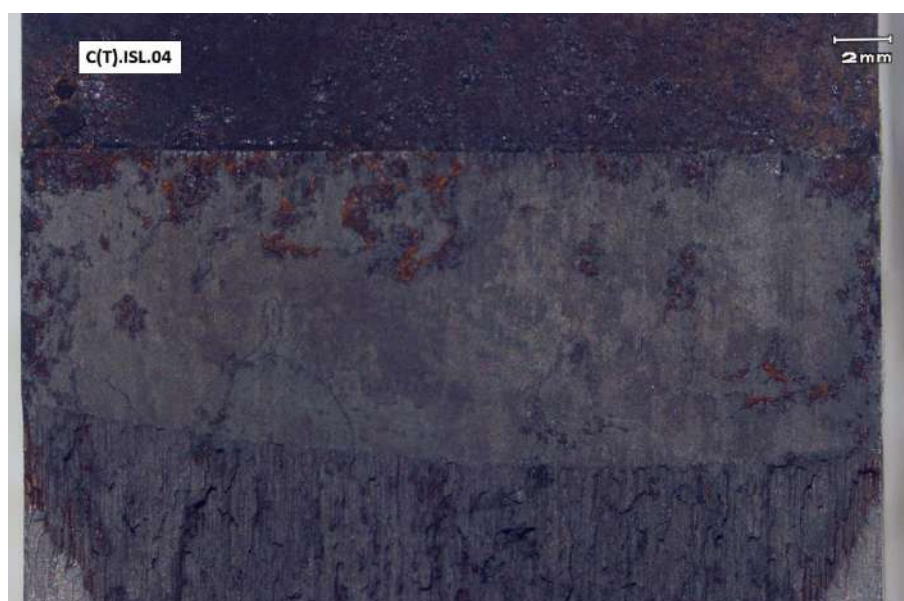
Figura 123 – Imagem em lupa estereoscópica da região da pré-trinca, entalhe e propagação no corpo de prova C(T).ISL.04 ensaiado em meio
