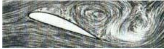
Figura 2.31 - Fluxo separado (estol) em volta do perfil (Fonte: CRESESB, 2007)
