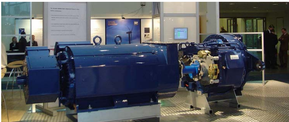
Figura 2.28 - Gerador conectado a caixa de engrenagens (vista a direita)
