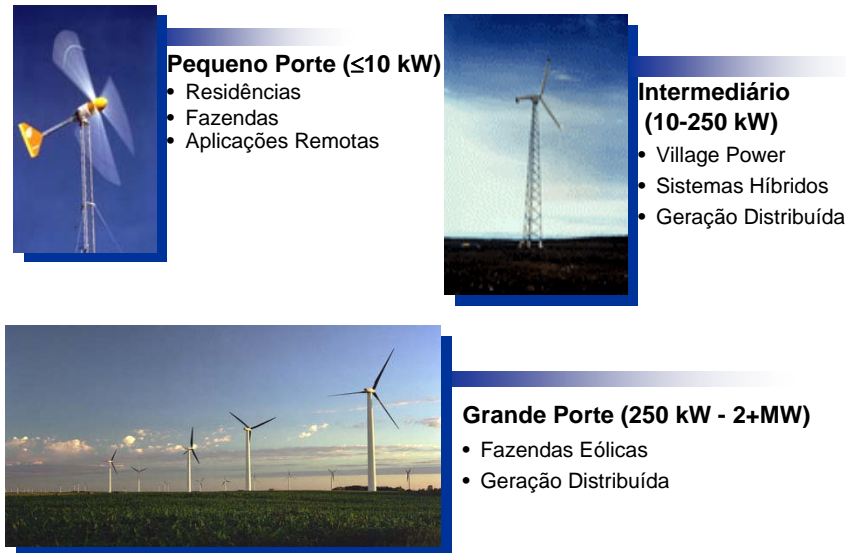
Figura 2.37 - Considerações sobre o tamanho das turbinas eólicas e suas principais aplicações (Fonte: NREL, 2006)
