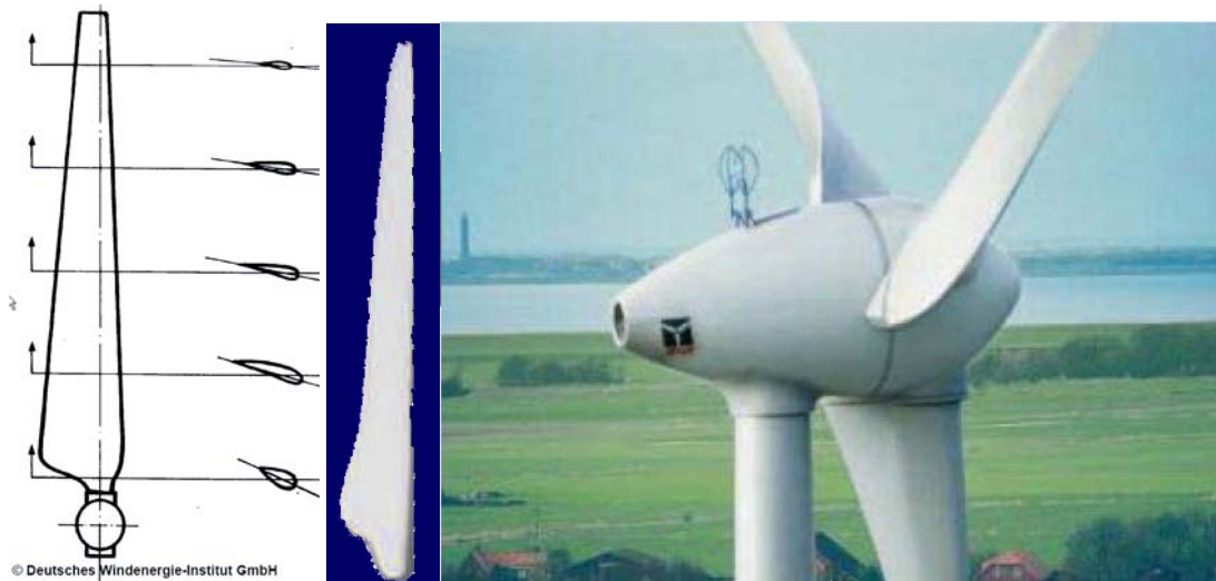
Figura 5.10 - Efeito de torção (Fonte: DEWI, 2004), perfil de pá (Fonte: ENERCON, 2007) e vista da nacele do modelo E-70 da ENERCON (Fonte: DEWI, 2004)
