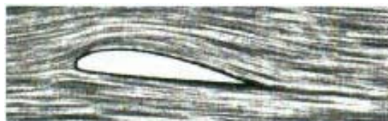
Figura 2.33 - Fluxo aderente ao perfil (Fonte: CRESESB, 2007)
