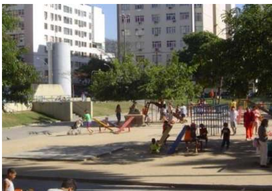
Figuras 2.22: (a) e (b) Praça Afonso Pena em dia ensolarado, e em evento chuvoso funcionando como reservatório de detenção
