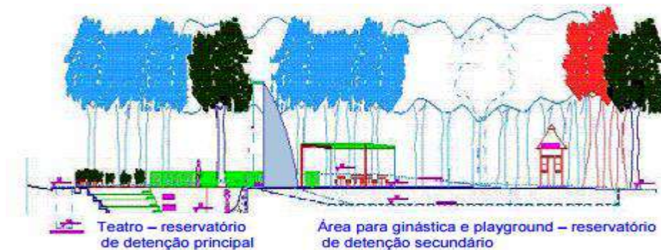
Figura 2.21: Perfil da praça Edmundo Rego em diferentes níveis, atuando como reservatório temporário Fonte: Miguez et al. , (2007)
