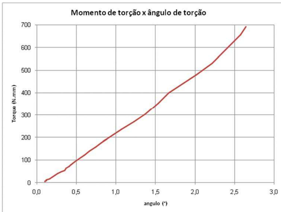
Figura V.35 – Gráfico do momento de torção pelo ângulo de torção ensaio 16/12/2016).
