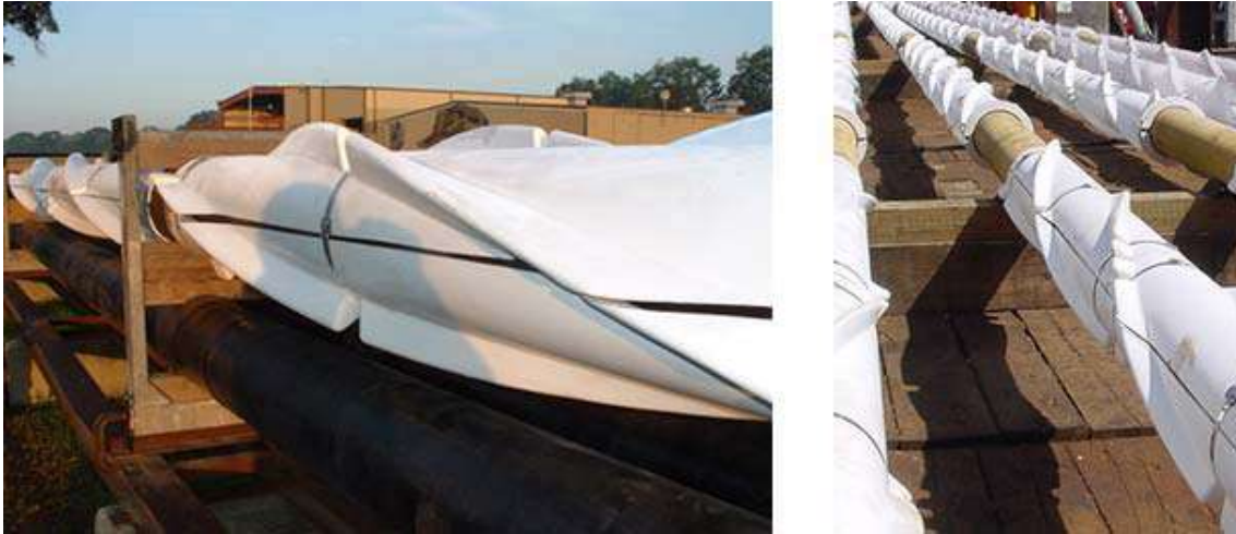
Figura III.19– Supressor de vórtice tipo helicoidal ( strakes ) [VIV SOLUTIONS, 2012].
