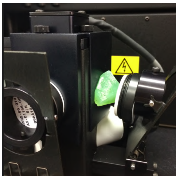
Fig 10: Detalhe da esfera de integração do espectrômetro UV/VIS/NIR com uma amostra posicionada para análise.
