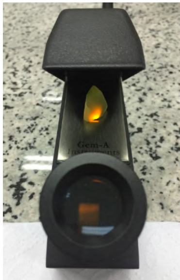
Fig 9: Refratômetro Gemológico para leitura dos índices de refração entre 1,30 a 1,81 com filtro polarizador e filtro de luz amarela (Schneider RF2).
