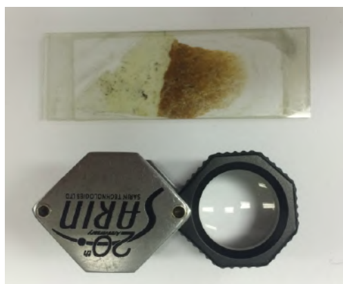
Fig 15: Lâmina delgada evidenciando o contraste entre o veio de opala (claro) e a calcedônia (marrom).
