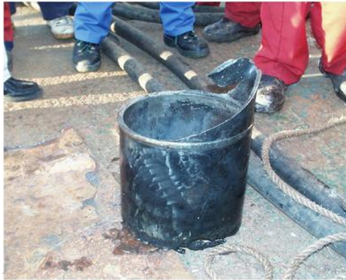
Figura 3.h) Falha estrutural em duto por fadiga devido VIV [12].
