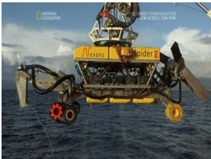
Figura 5.d) - Equipamento utilizado para escavação de trincheiras [7].
