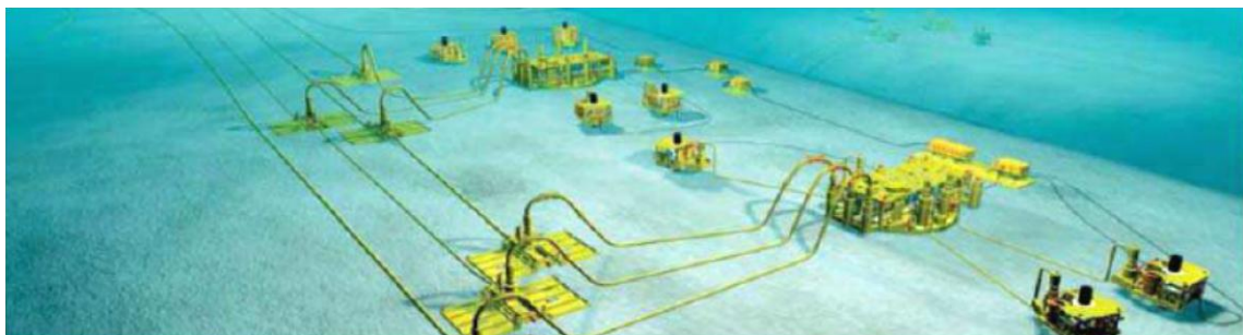
Figura 2.4 – Flowlines conectados ao PLEM [13].
