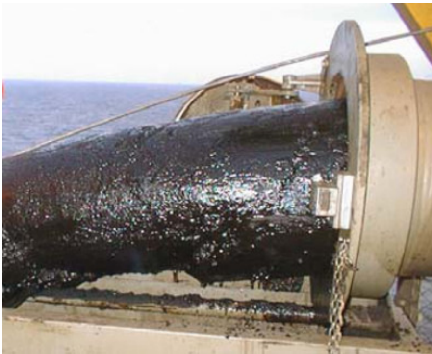
Figura 12 - Plugue de parafina removido por PIG - Fonte: http://www.hydrifact.com
