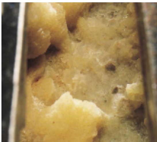
Figura 9 - Incrustação por carbonato de cálcio - Fonte: Oilfield Review - Autumn 1999
