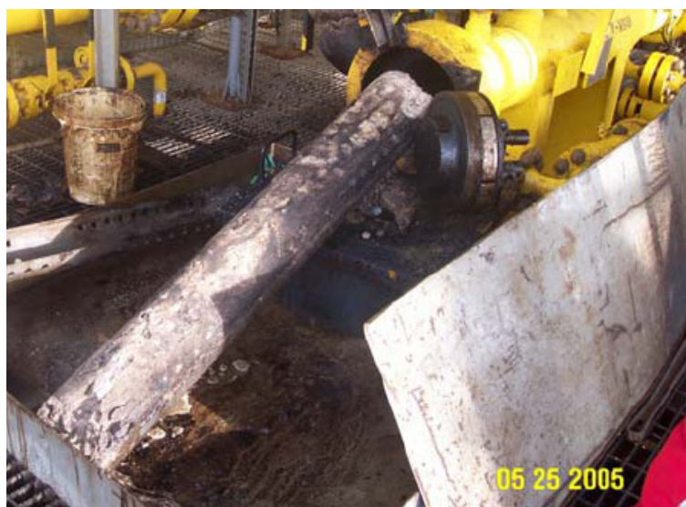
Figura 4 - Plugue de hidrato removido do FPSO Brasil, localizado no campo de Roncador – Fonte: Nascimento et. al – Paper OTC 12291
