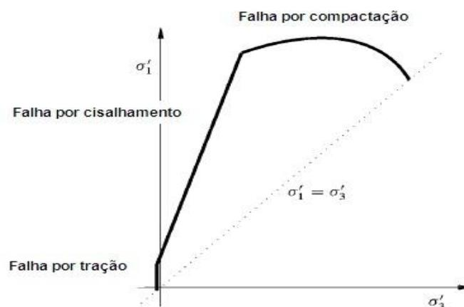
**Figura 2.10 - Localização de vários modos de falha no espaço de tensões principais. Adaptado de FAERJ (2008).**
