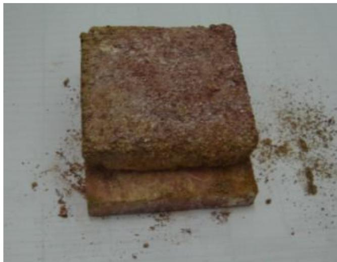
Figura 26 - Corpo de prova após ensaio de cisalhamento direto
