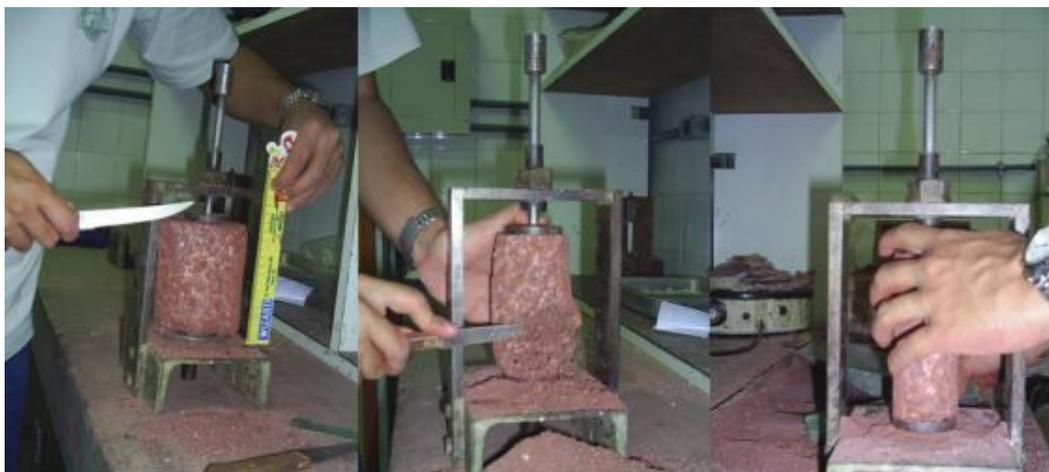
Figura 36 - Processo de desbaste e moldagem do corpo de prova para o ensaio triaxial
