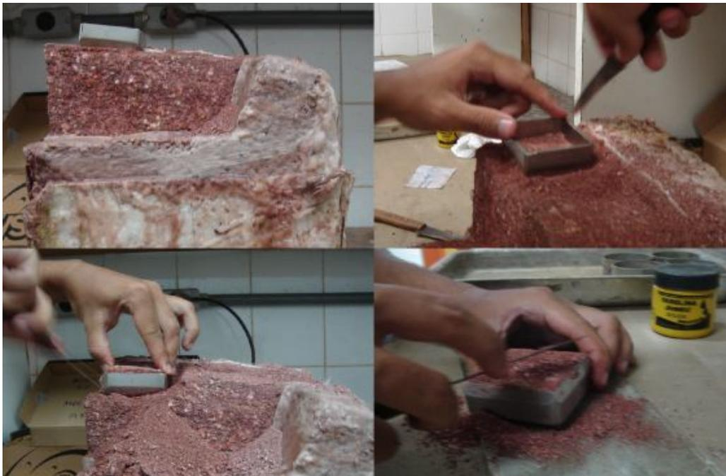
Figura 22 - Etapas da moldagem dos corpos de prova do ensaio de cisalhamento direto
