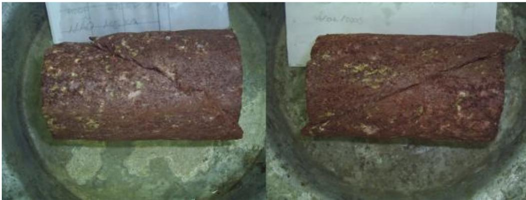
Figura 41 - Corpos de prova rompidos
