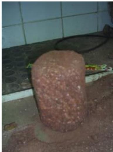
Figura 35 - Desbastes preliminares, início da moldagem do corpo de prova do ensaio de compressão triaxial
