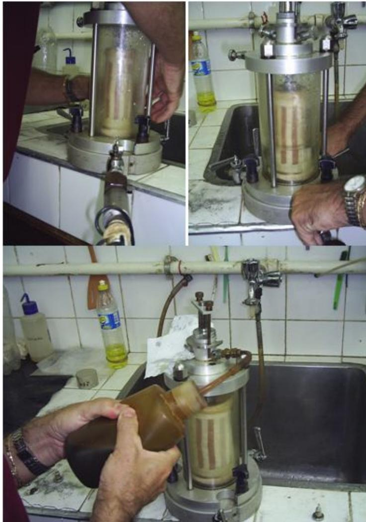
Figura 40 - Sequencia de montagem do ensaio triaxial, preparação da célula
