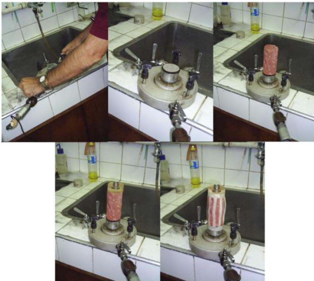
Figura 38 - Sequencia de montagem do ensaio triaxial, colocação do CP no pedestal
