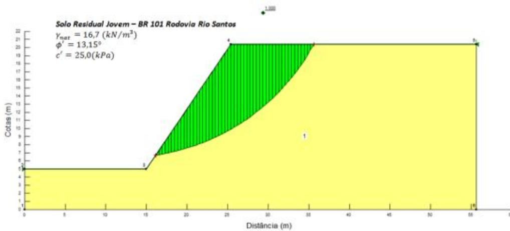
Figura 68 - Seção B, simulação da superfície de ruptura para  $c'$  igual a 25,0 (kPa)
