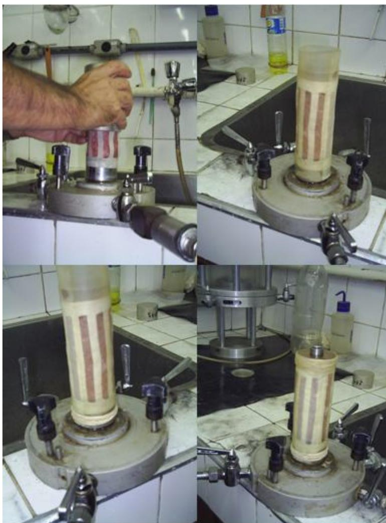
Figura 39 - Sequencia de montagem do ensaio triaxial: encamisamento do CP
