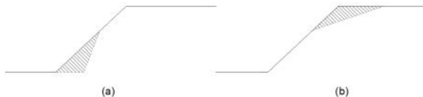
Figura 4 - Exemplos de modificação da geometria em taludes, cortes de mesmo volume de material: (a) corte instabilizante, (b) corte estabilizante.
