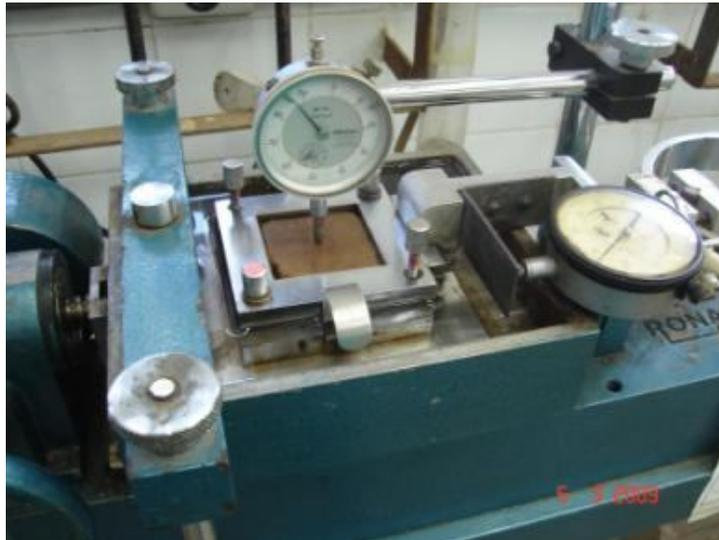
Figura 23 - Detalhe da prensa de cisalhamento direto
