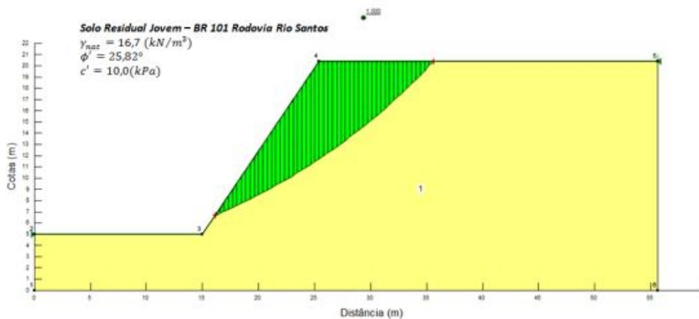
Figura 65 – Seção B, simulação da superfície de ruptura para  $c'$  igual a 10,0 (kPa)
