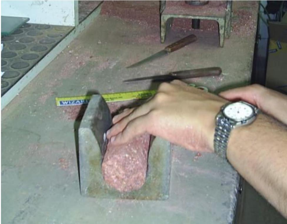
Figura 37 - Nivelamento refinado do topo e da base do corpo de prova do ensaio triaxial
