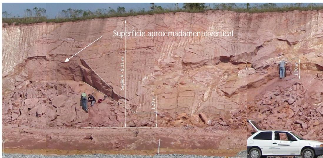
Figura 76 – Apresentação de superfície aproximadamente vertical entre a massa de solo rompido e intacto para a seção A
