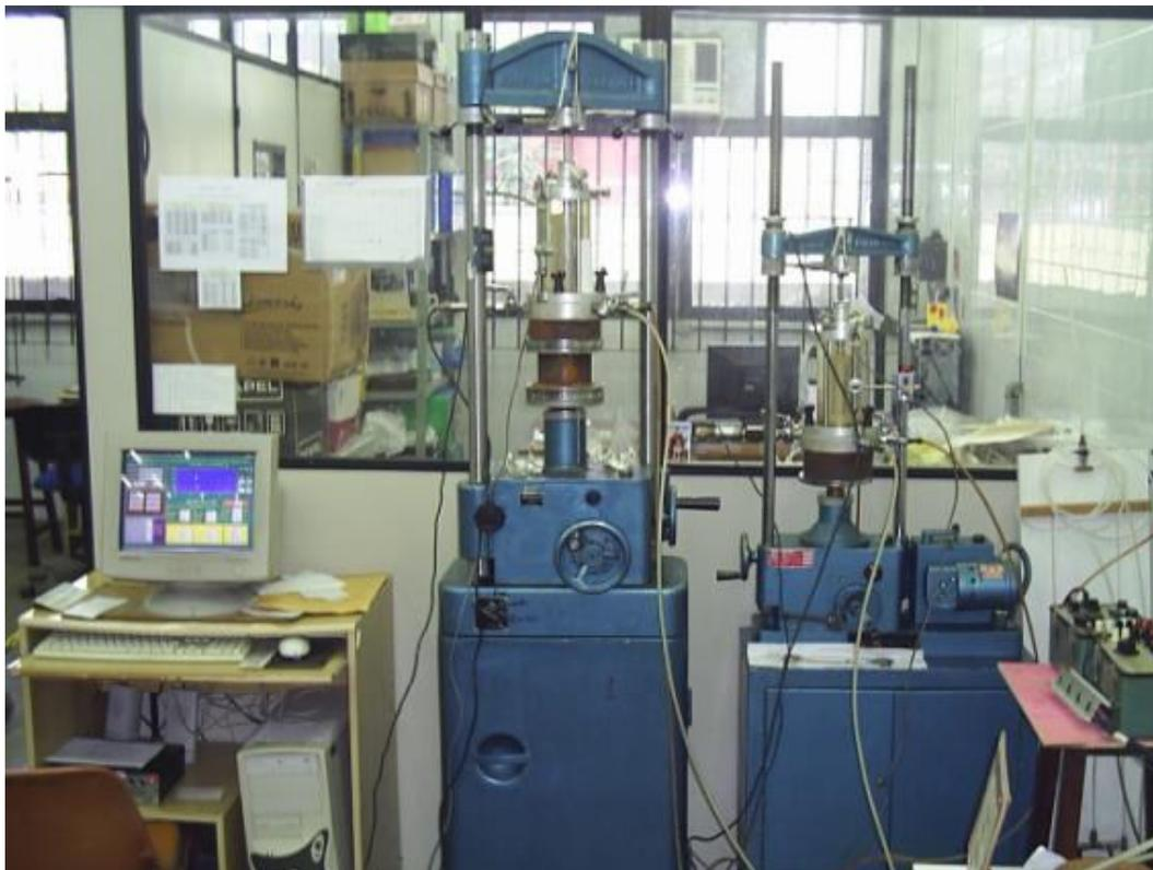
Figura 33 - Prensas eletromecânicas utilizadas no ensaio de compressão triaxial e computador com aplicativo de aquisição
