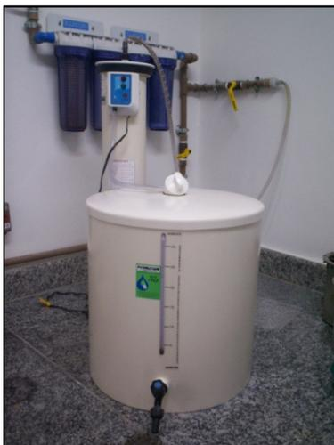
Figura 25. Deionizador de Água.
