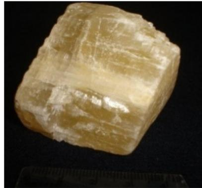
Figura 21. Gipsita (Fonte: [www.jisanta.com/Geologia](http://www.jisanta.com/Geologia)).
