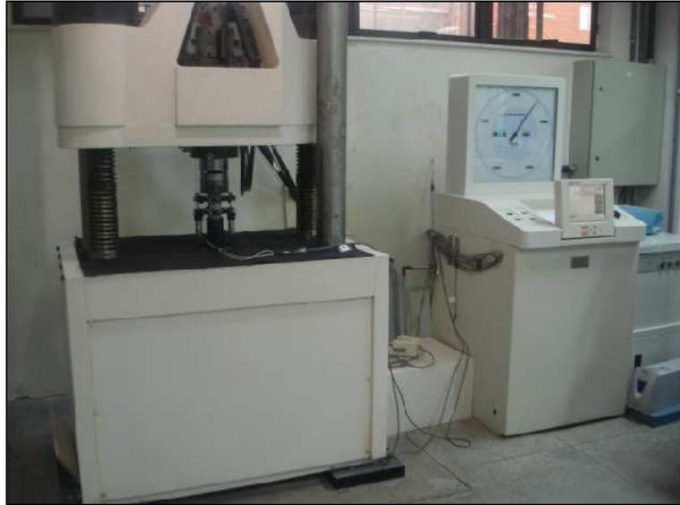
Figura 40. Prensa *Shimadzu UH-F 1000 KN*.
