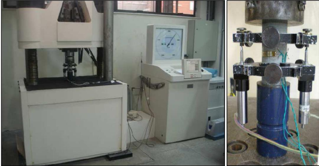
Figura 44. Ensaio de Resistência à Compressão.
