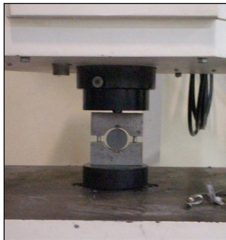
Figura 45. Ensaio de Tração por Compressão Diametral.
