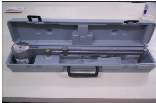
Figura 38. Balança de Lama.
