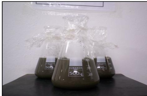
Figura 36. Ensaio de Água Livre.
