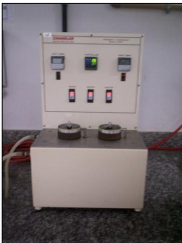
Figura 32. Consistômetro Atmosférico.
