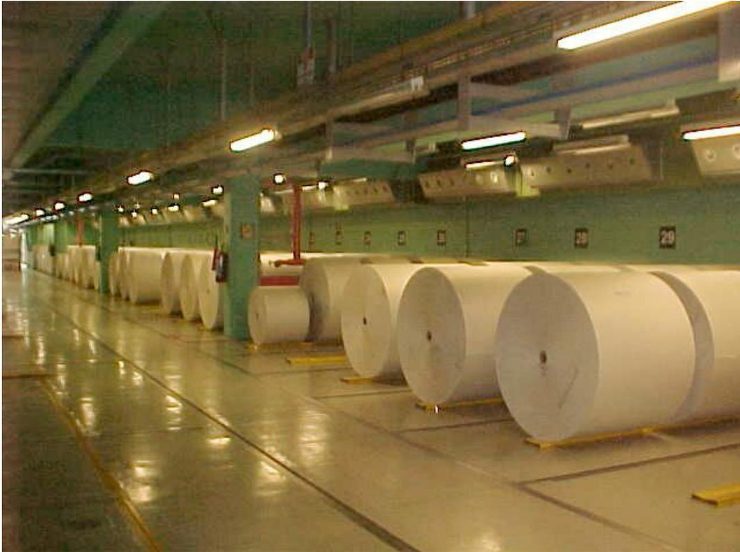
Figura 3.4 - Alimentação de papel das rotativas (bobinas preparadas)
