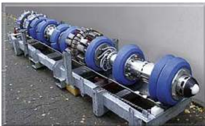
Figura 2.7 - Exemplo de Pig Ultra-Sônico para inspeção de dutos. [8]
