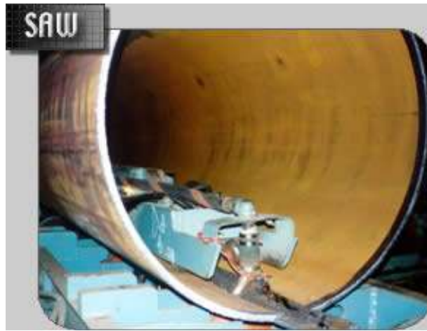
Figura 2.3 – Duto submetido ao processo de soldagem dupla DSAW. [5]
