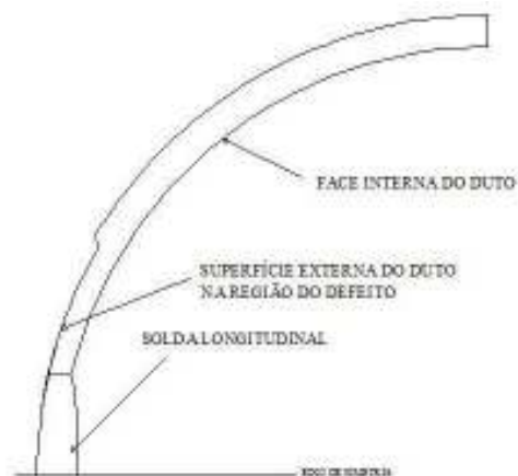
Figura 3.1 – Corte Transversal na Região do Defeito. [9]
