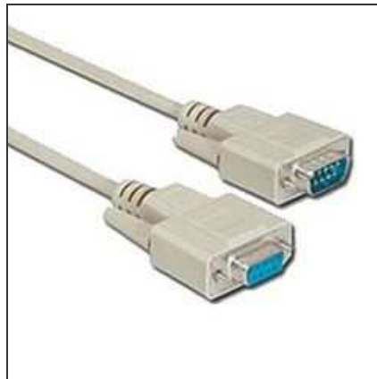
figura 6.1 – Cabo serial padrão RS-232C com conector DB9 (fonte: http://www.solbet.com/ )
