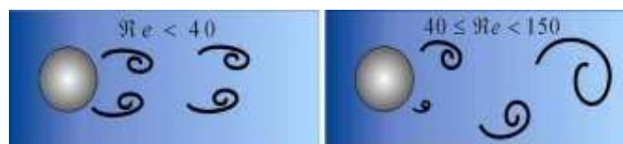
Figura III-6 – Exemplo da variação da esteira de von Karman com o número de Reynolds (SANTOS [8]).
