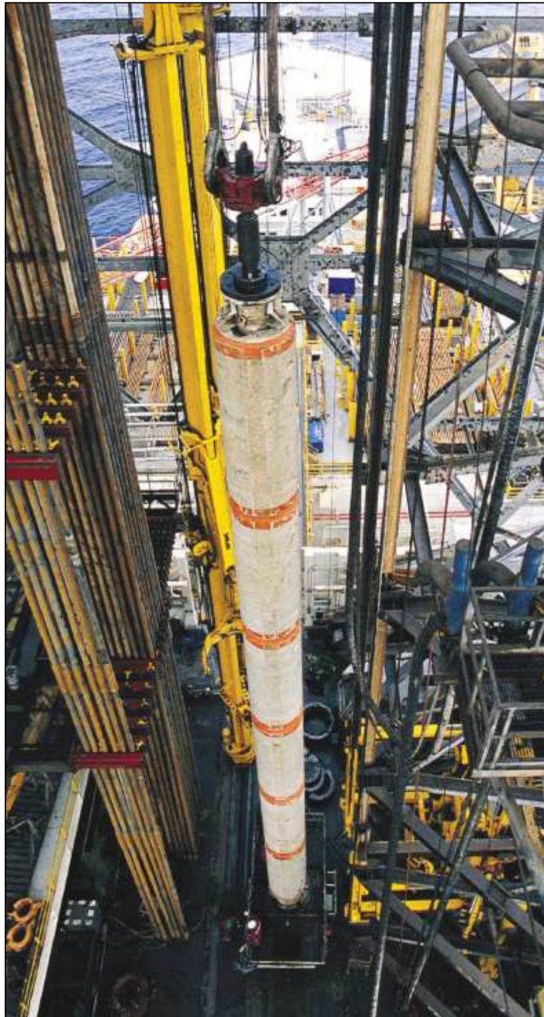
Figura 9.2.3 – Flutuador ao longo de um riser .
