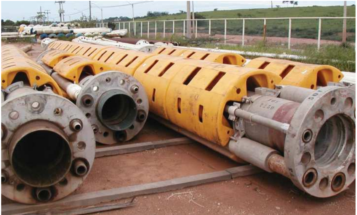
Figura 9.2.4 – Conjunto: riser , linhas auxiliares e flutuador.
