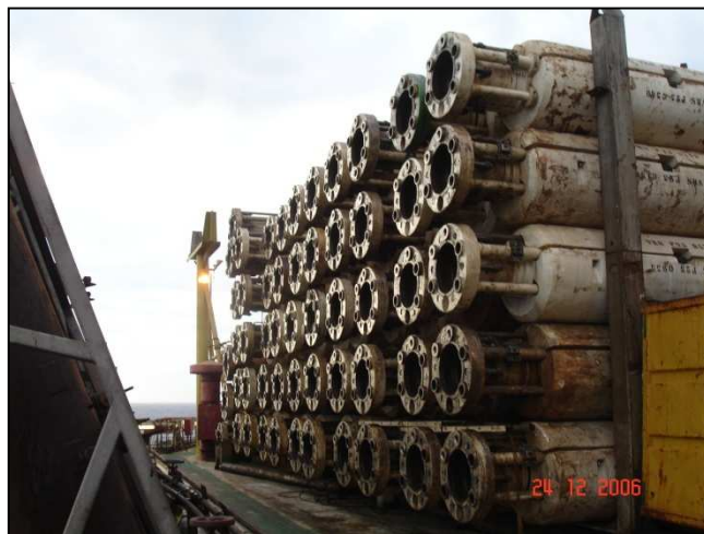
Figura 9.1.1 – Risers de perfuração no convés P23.
