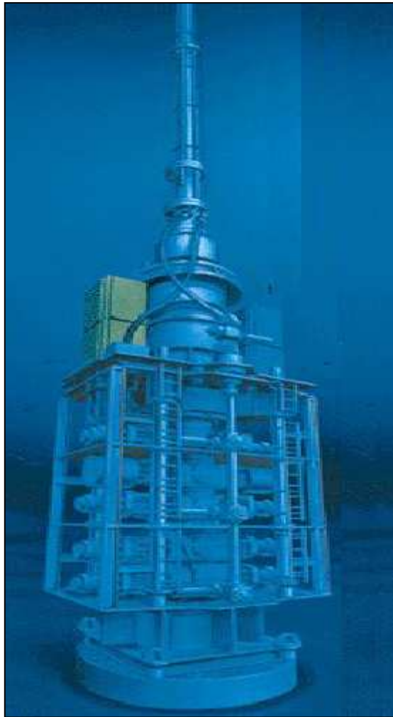
Figura 2.2.2 – Representação de um BOP [1].
