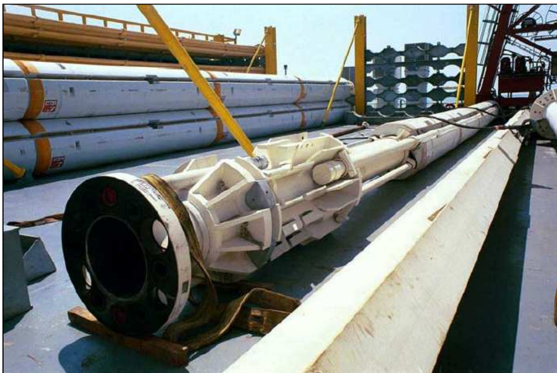
Figura 9.2.1 – Riser com flutuador em alguns trechos.
