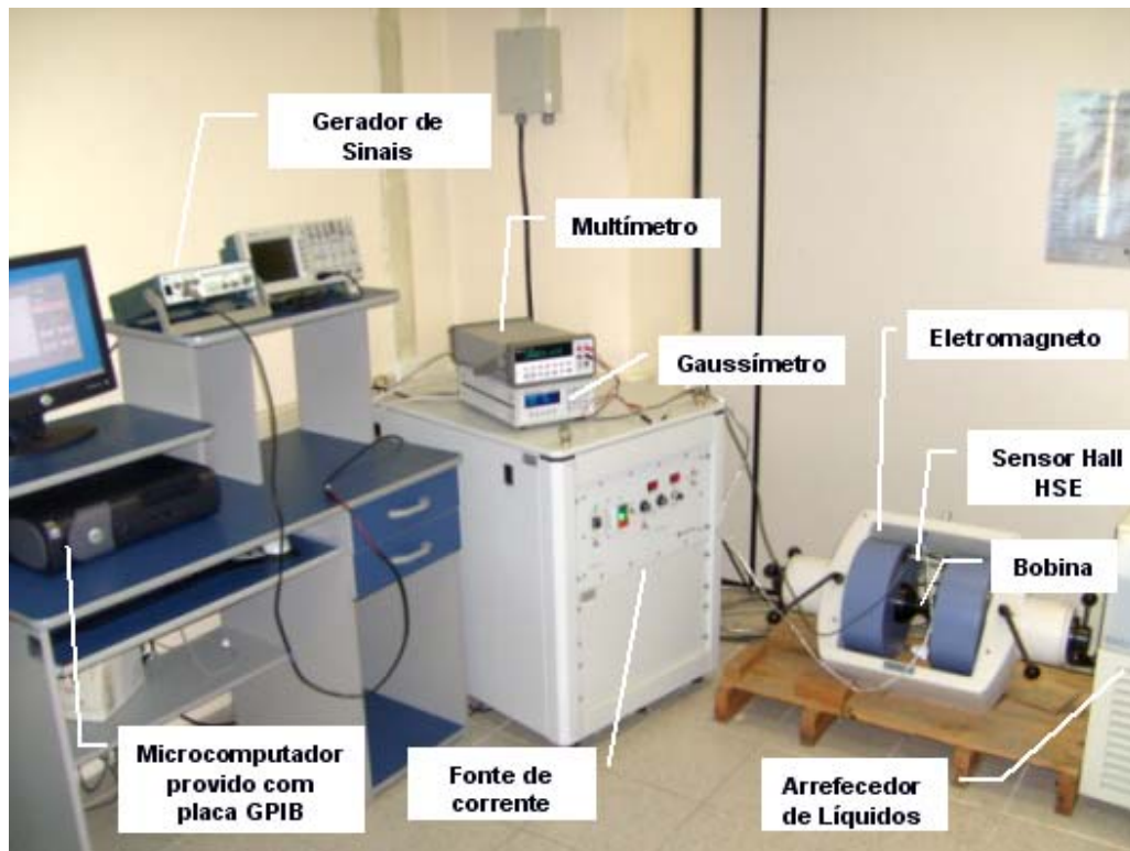
Figura 21: Equipamentos envolvidos no sistema SGPIB.
