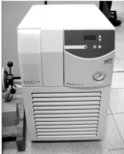
Figura 13: Resfriador de líquidos ( Chiller ).
