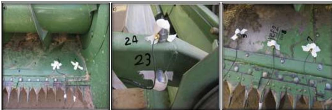
Figura 1.4. Análise modal da estrutura de uma máquina de corte para reduzir os níveis de vibração (2013).
