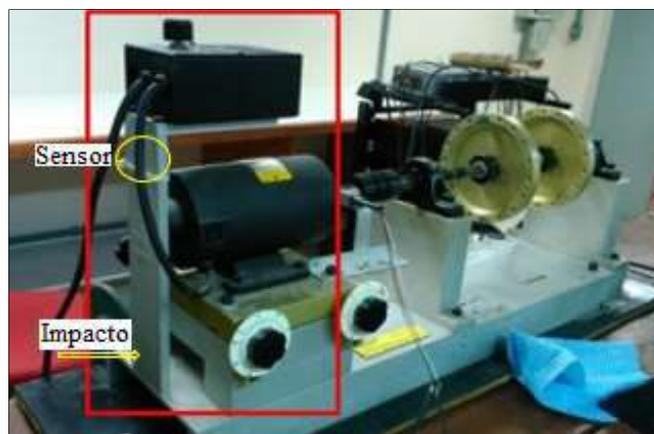
Figura 5.4. Haste metálica do rotor-kit (círculo: posição do sensor, flecha: local do impacto)
