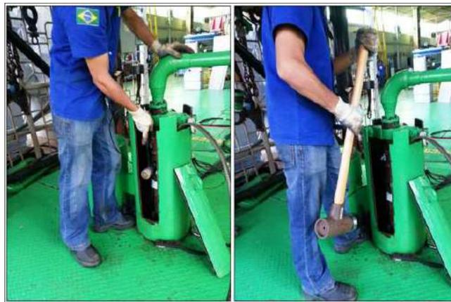
Figura 5.14. Impacto com Martelos na estrutura na cabeça do poço (esquerda: martelo pequeno, direita: martelo grande).
