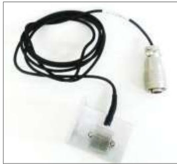
Figura 5.2. Acelerômetro resistivo da *Measurement Specialties* modelo 4810B – 12
