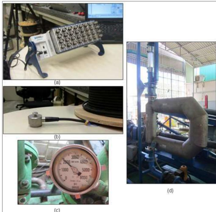
Figura 5.12. Instrumentação utilizada: (a) placa A/D NI® (b) acelerômetro piezoelétrico à prova d'água (c) transdutor de pressão (d) transdutor de vazão.
