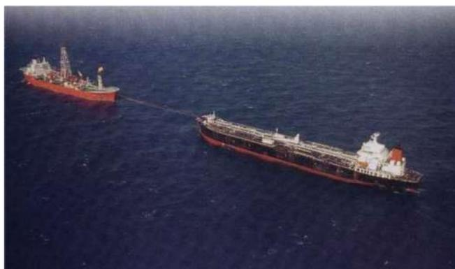
**Figura 1.1:** Operação de *Offloading*
