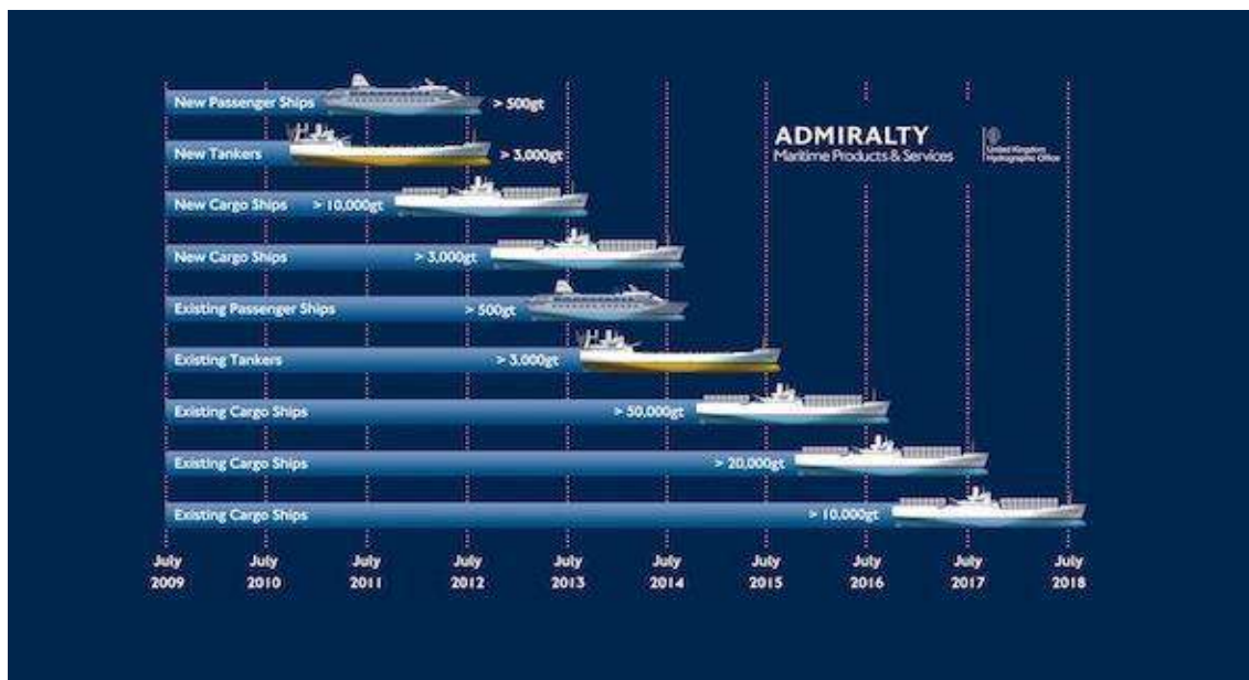
Figura 1 – Requisitos para instalação do ECDIS.
