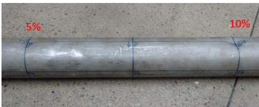
Figura III.16: Modelo tubular T1-A após os testes de simulação dos danos.
