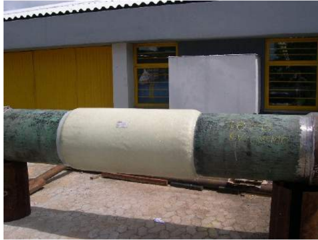
Figura II.14: Material compósito formado por sucessivas camadas de tecidos e mantas de fibra de vidro ou fibra de vidro impregnados com matriz polimérica em epóxi [22]
