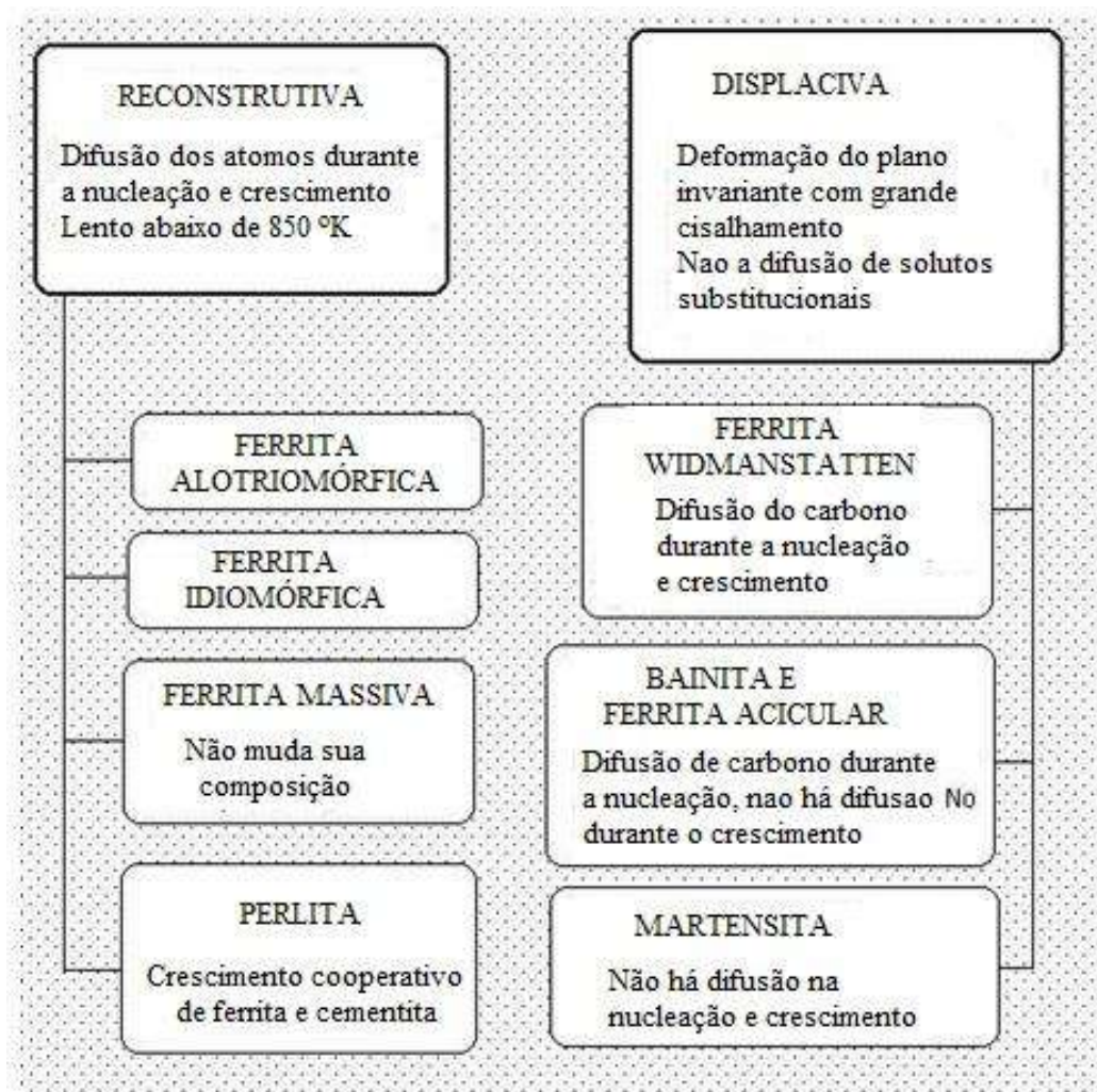
Figura 2. 2. Produtos de transformação a partir da Austenita (adaptada de: Bhadeshia, 1995).
