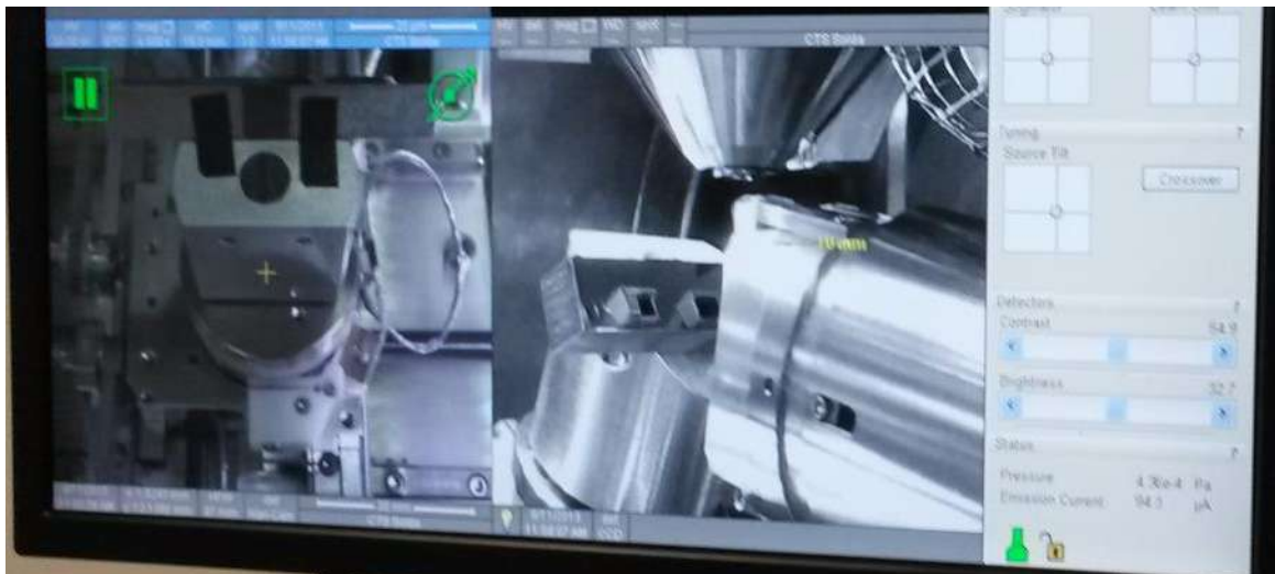
Figura 3. 9. Imagem do corpo de prova inclinada dentro da câmara de vácuo do microscópio eletrônico de varredura (MEV).
