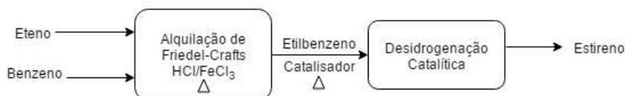
Figura 2.7: Fluxograma simplificado do processo convencional para obtenção do monômero estireno.
